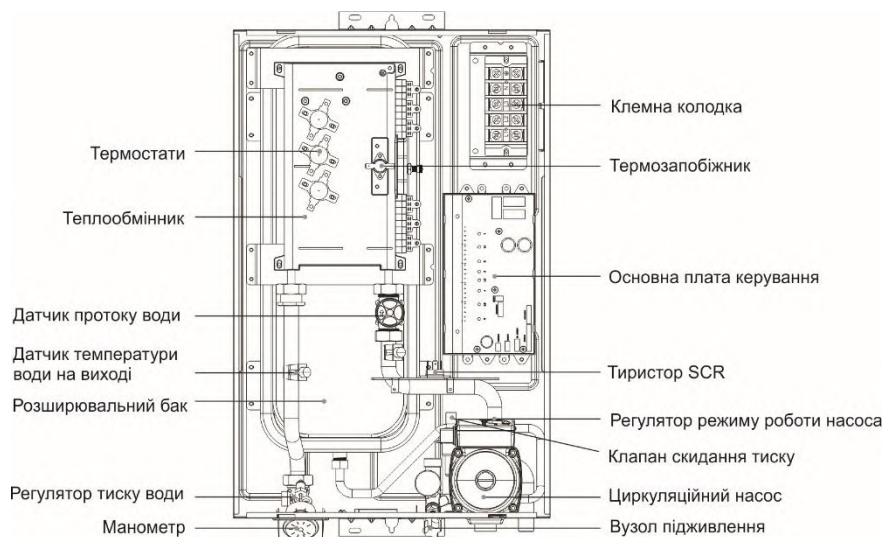
Мал. 2. Схема внутрішньої конструкції виробу
