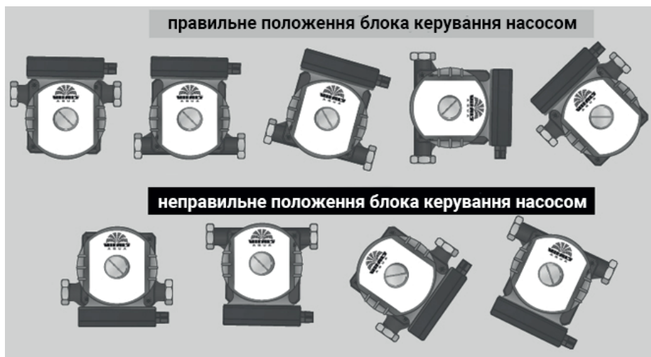
Рисунок 3. Схема положень встановлення насоса у систему.
